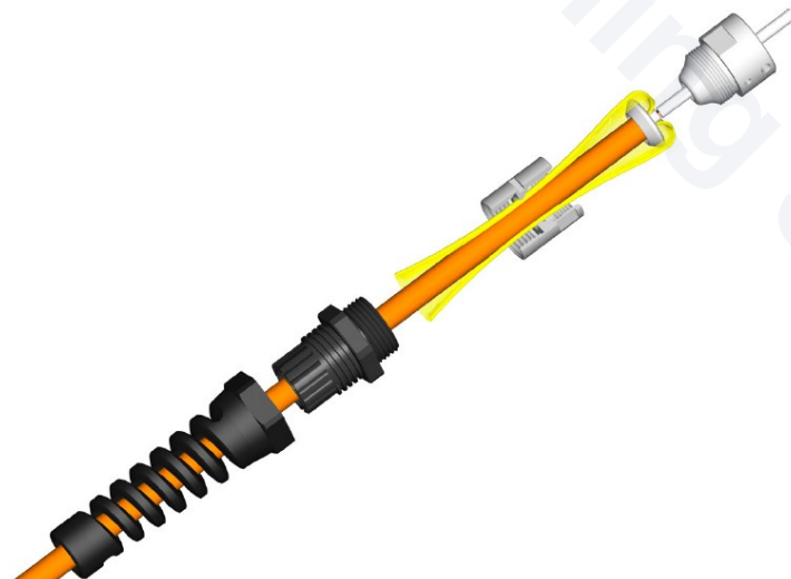
Figura 3: Sequenza Inserimento Componenti e Percorso dei Filati di Kevlar.
